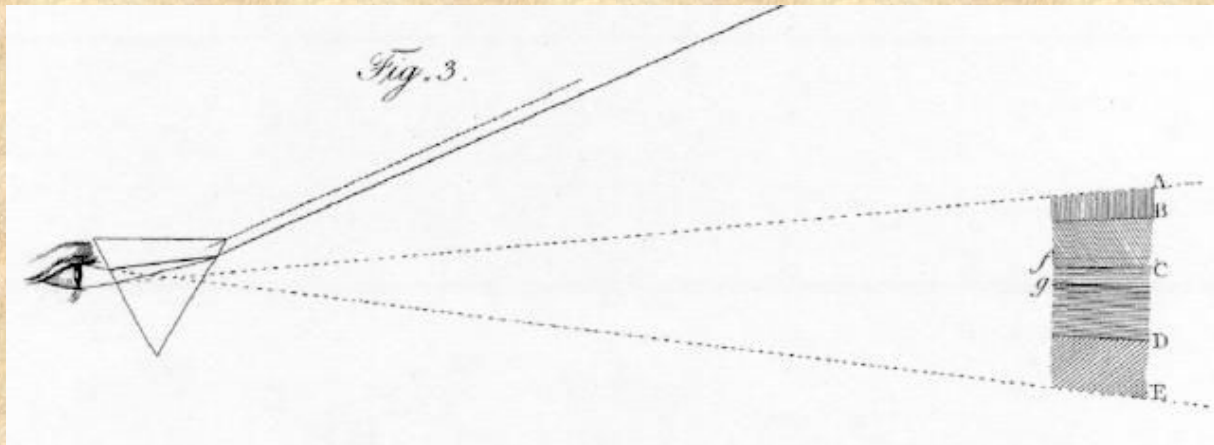
La semplice osservazione di Wollaston mediante un solo prisma.
